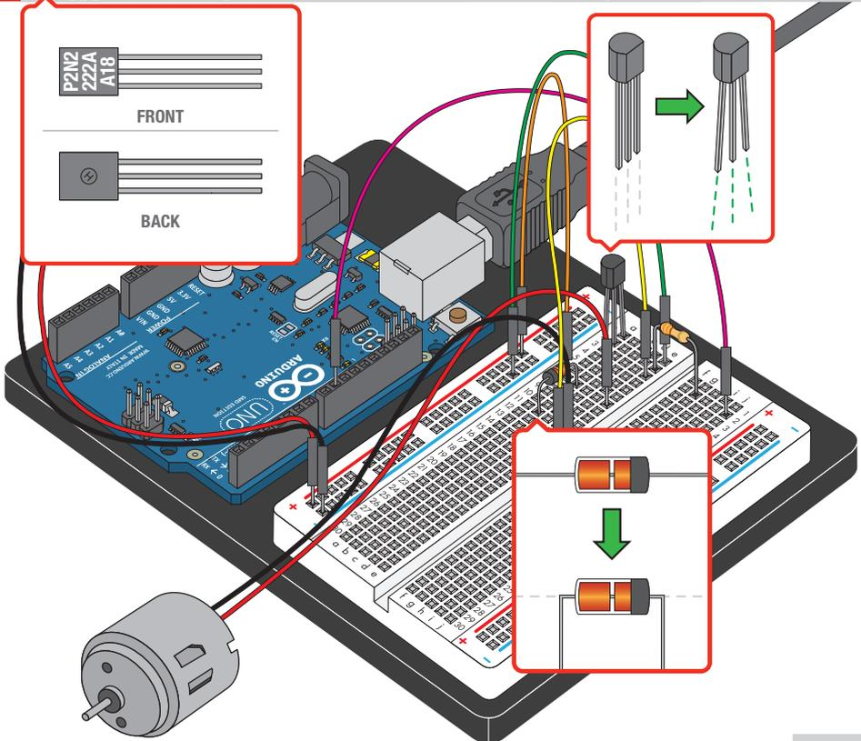
Circuit 12 : Spinning a Motor
