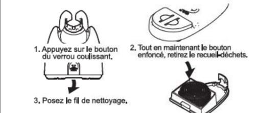
Si le capuchon en mousse et l'éponge de nettoyage ne suffisent pas à essuyer la panne, l'achat d'un fil de nettoyage peut faciliter le nettoyage.
