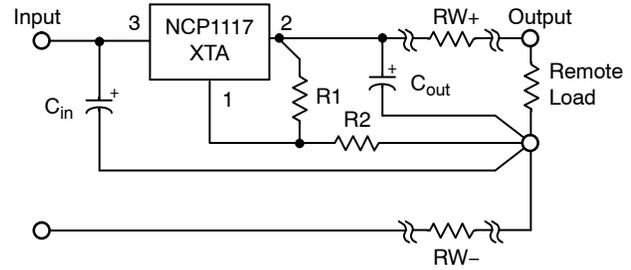
**Figure 26. Load Sensing**
