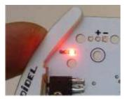
Pressez sur les moustaches, les LEDs s'allument lorsque les microswitch correspondants sont actifs.
